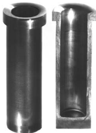
Рис. 3. Деталі, отримані в штампі для холодного видавлювання з розтягом
